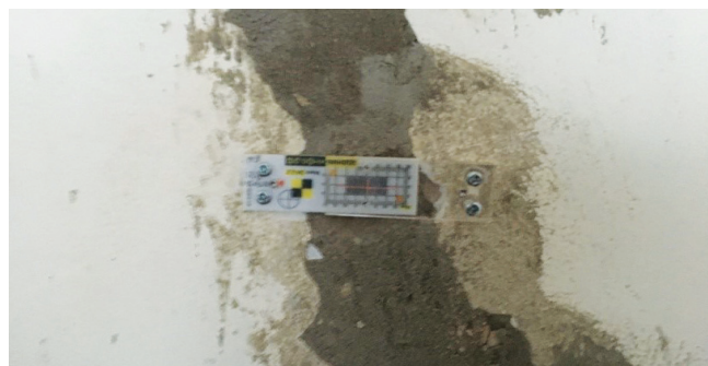
Рис. 3. Деформационные маркеры на стене здания
