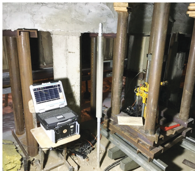
Рис. 7. Мобильная установка статического зондирования во время испытания
