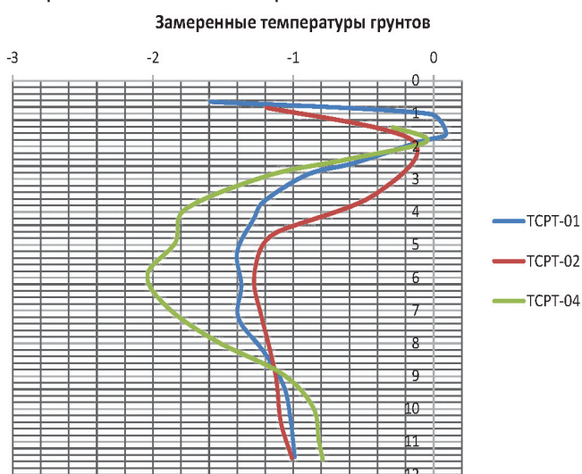
Рис. 10. Замеренные температуры грунта по глубине в точках ТСРТ-01, ТСРТ-02 и ТСРТ-04
