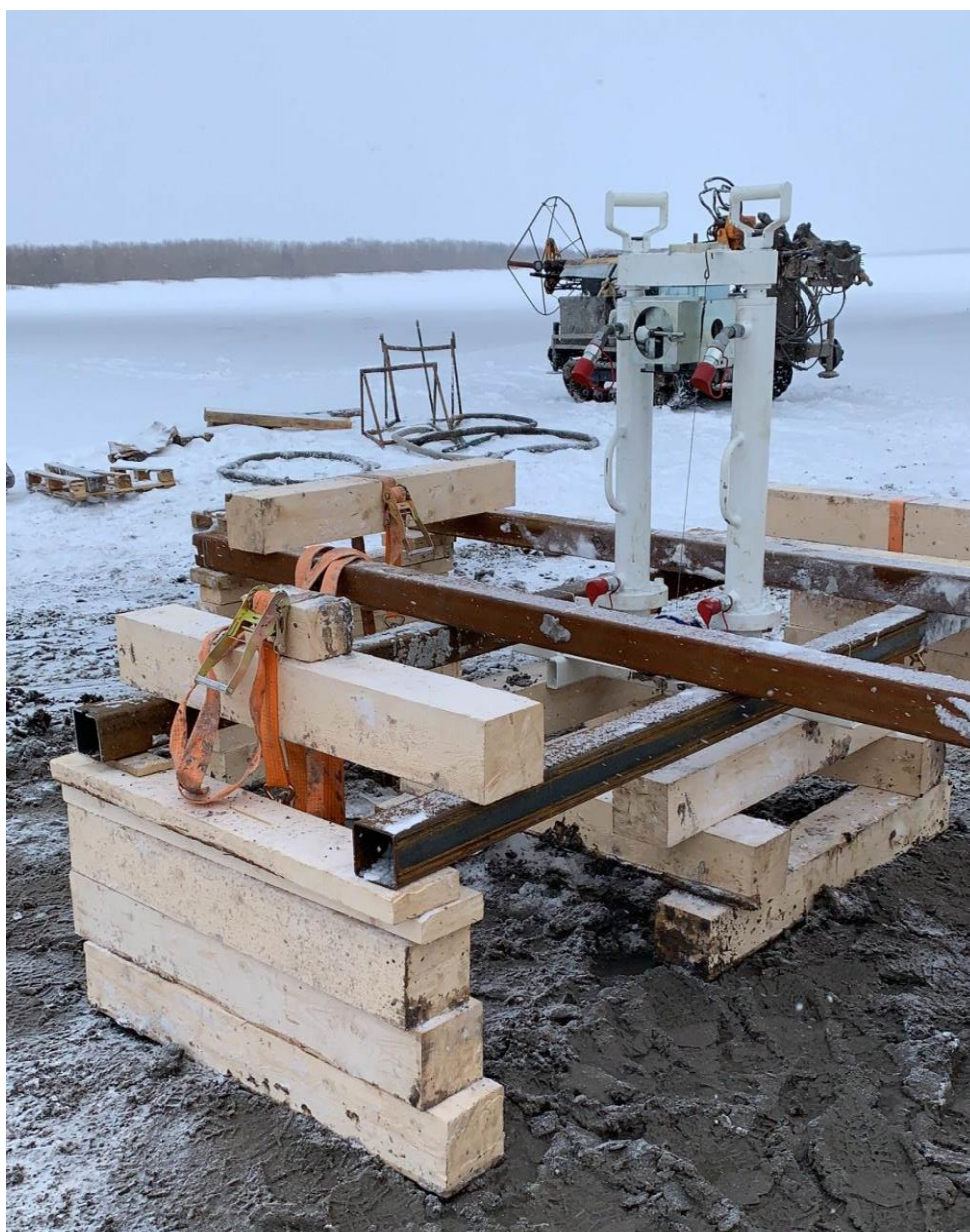
Рис. 4. Мобильная установка статического зондирования с закреплением в ледяном покрове
