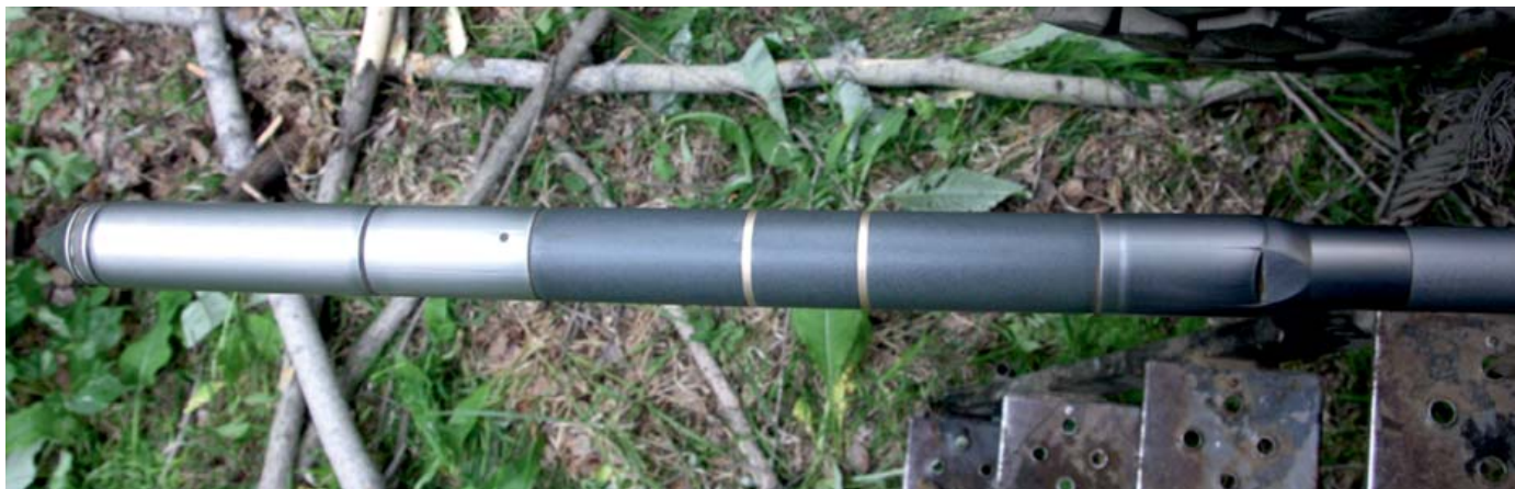
Рис. 6. Конус для статического зондирования с измерением удельной электропроводности грунта (RCPT)
