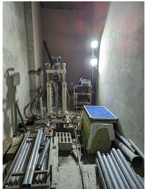
Статическое зондирование малогабаритной установкой
